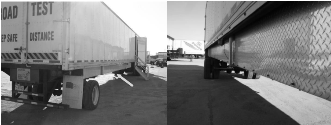
Figura 1: FHWA RWD foto de lado y acercamiento de seis sensores laser
